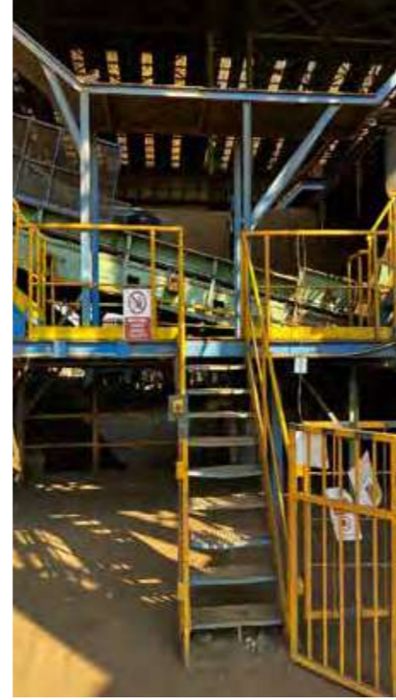
Hurda sahasında bulunan eleklerin personele zarar vermesini engellemek için kapılara interlock / makinayı durdurma sistemleri kurulmuştur.
